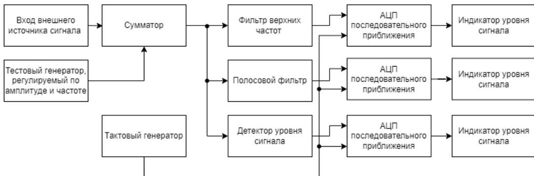
Рисунок 1. Структурная схема анализатора спектра
