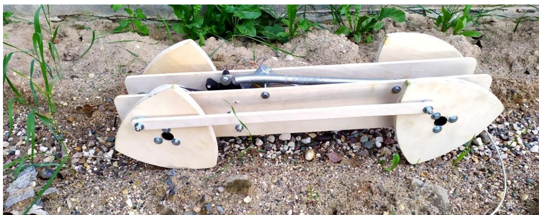
Рис. 2. Испытания ходовой части на рыхло-каменистой поверхности
