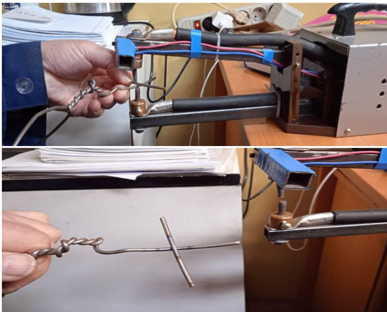
Рис.2. Контактная сварка в работе
