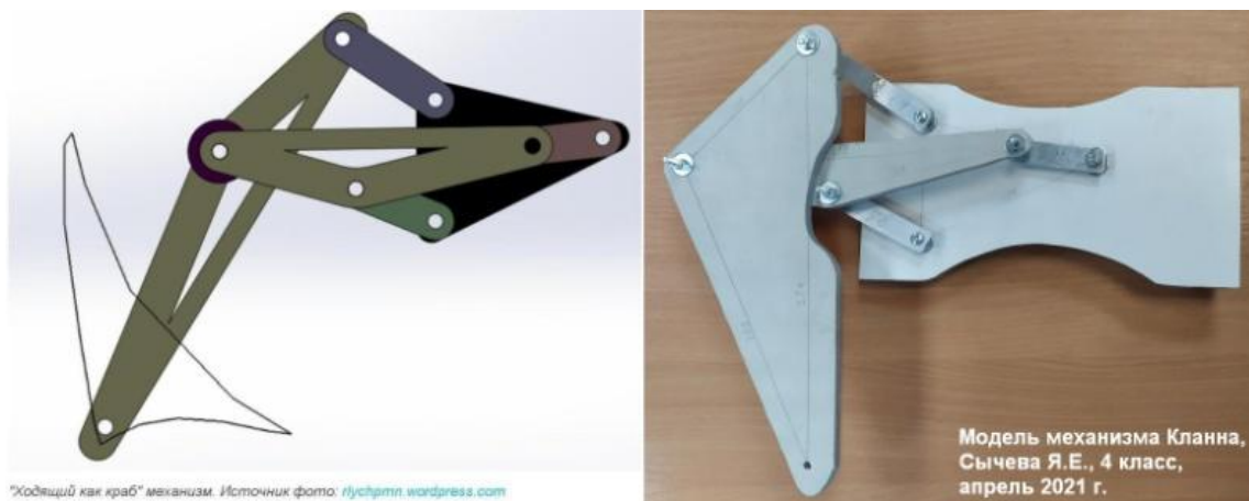
Рис. 1. Механизм Кланна, траектория опорной точки и модель устройства
