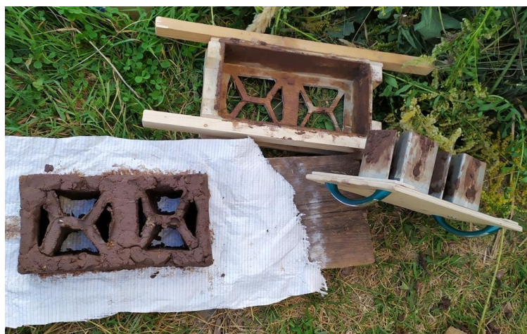
Рис. 4. Металлическая пресс-форма, основание опалубки, кирпич.
