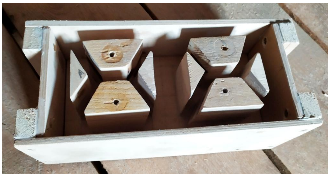
Рис. 1. Первая деревянная опалубка (неудачная).
