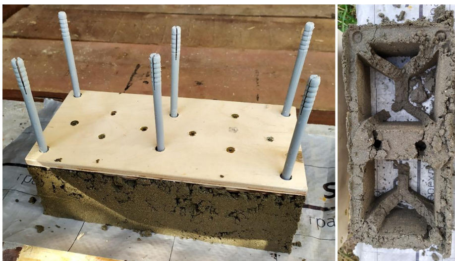
Рис. 2. Вторая пресс-форма и результат испытаний (отрицательный).
