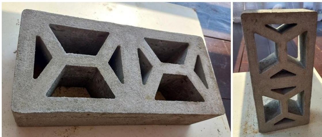
Рис. 6. Бетонный кирпич из капролоновой пресс-формы
