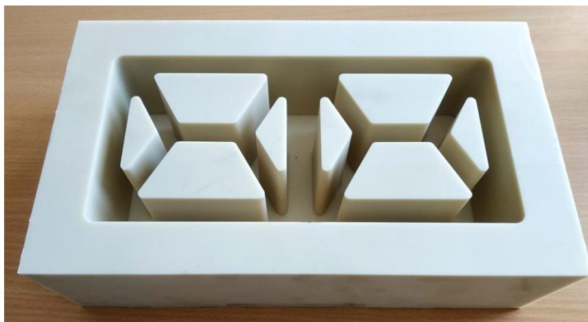
Рис. 5. Пресс-форма из капролона для бетонного кирпича.
