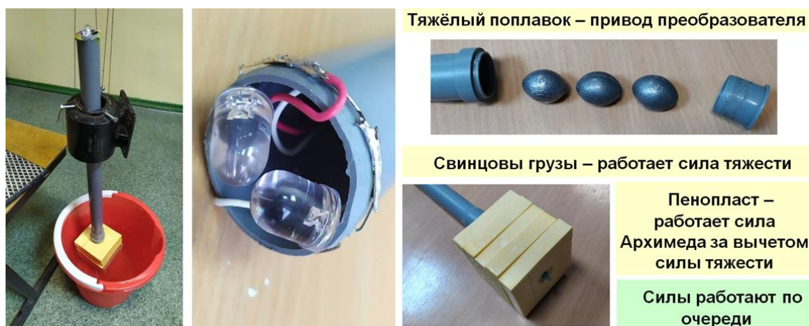
Рис.2. Установка с тяжёлым поплавком.
