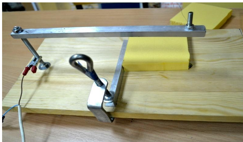
Рис.2. Станок для горячей резки пенопласта.
