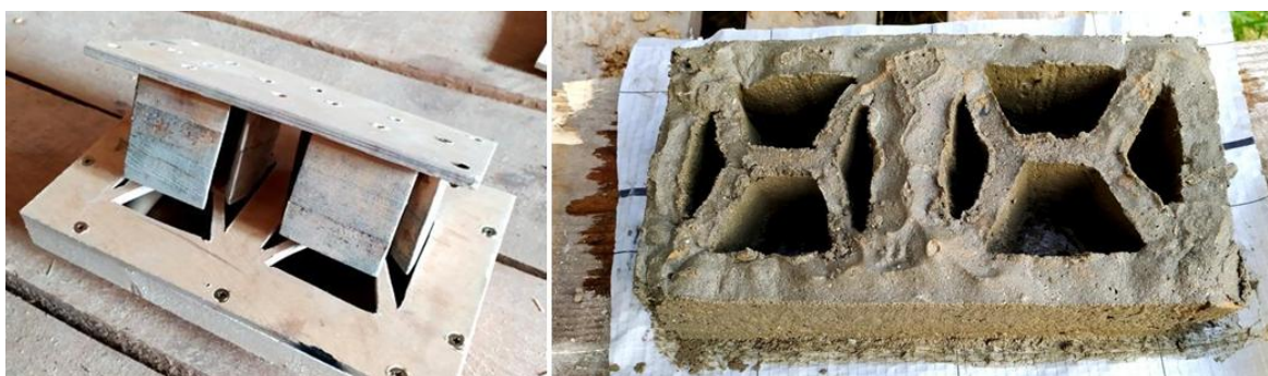
Рис. 3. Новый сырой кирпич из раствора тяжёлого бетона.
