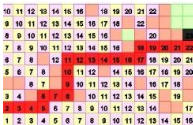
Рис. 1. Результат работы алгоритма Ли и его визуализация
