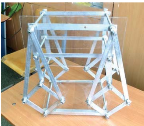
Рис. 1. Четыре механизма Липкина с прямоугольником из оргстекла
